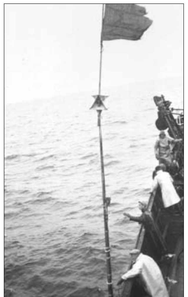
Áðrenn navigatiónstøknin gjørdist so framkomin, var hent við eini "markaboyu", sum kundi staðfesta nágreiniliga positiión.
