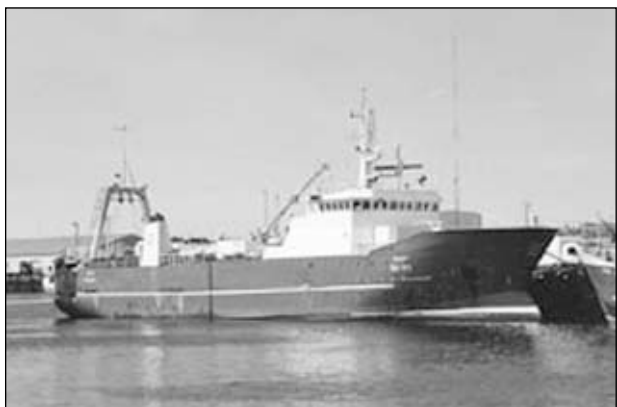
Eitt av skipunum hjá Torbjørnfyrirkuni er frystitrolarin Hrafn GK 111. Hann er 59 metur til longdar, 1067 bruttots og maskinan er 2000 hk.
