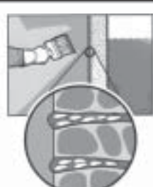
Vatntetting av betong
