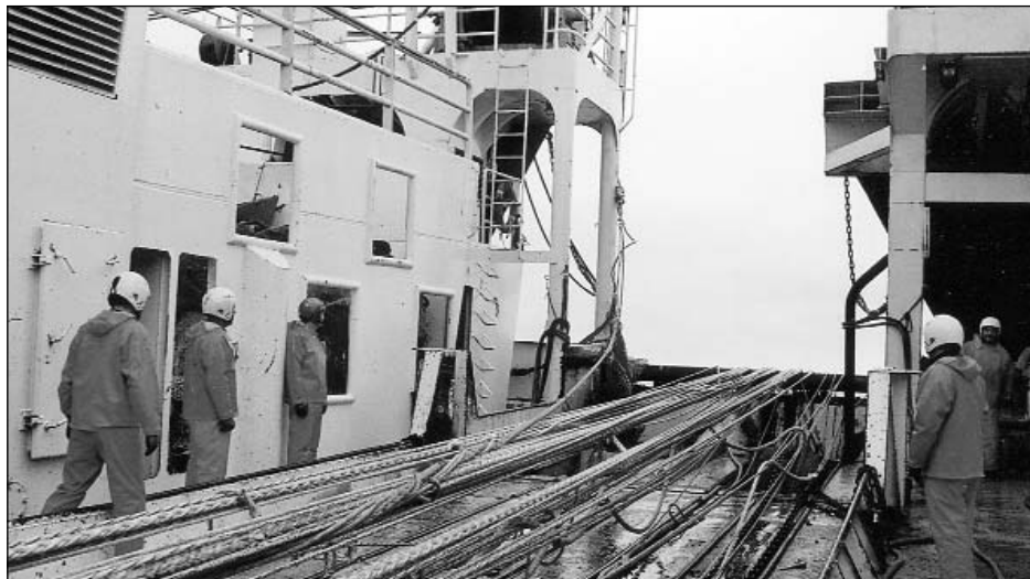
Trolíð fer út. Svartkjaftatrolini eru flóttitrol. T.v.s. tey fiska uppi í sjónum. Tey síggja löggin út, sum "berar línir", men tey reka fiskin væl saman, sum so gjarna skal enda afturi í posanum. Mennirnir á dekknum hava altíð hjálm á høvðinum, tá teir hála ella koyra trolíð út.
