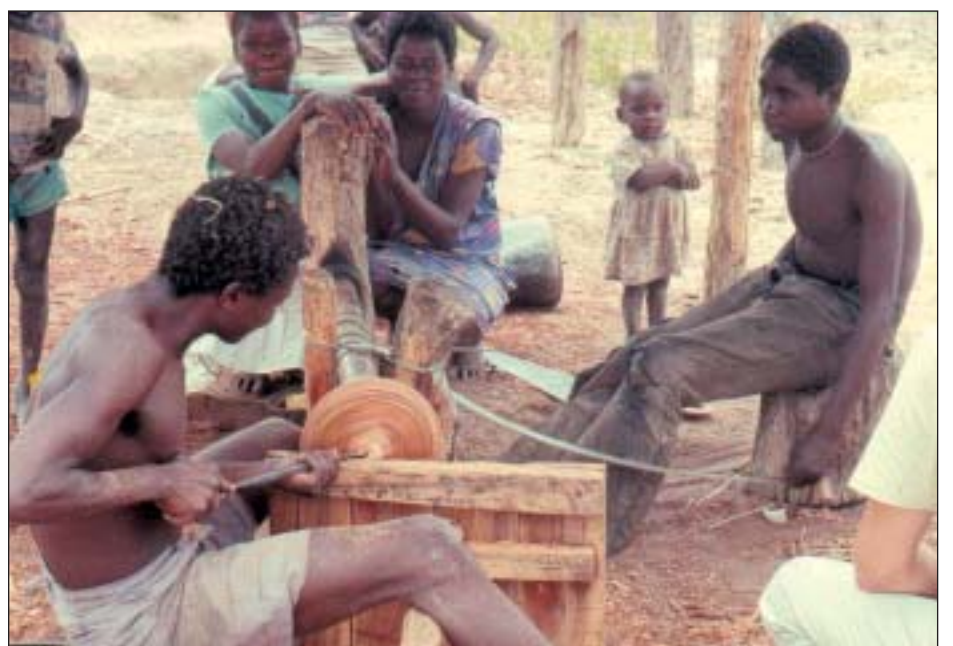
Trædrejere er nogle unge mænd der arbejder med at fremstille drejede træskåle. Deres drtejebænk er fremstillet fra bagtøjet på en havareret lastbil.
