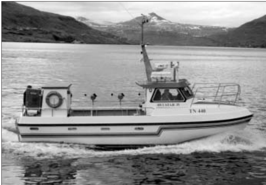
“Tvíburðar” hefur ein 360 hk Volvo motor, ið gevrur bátinum eina ferð uppá 20 míl. Akkumulatorarnir eru so mikið stórir, at ein kann liggja og veiða við sløktum motori í uml.10 tíma, greiður Mortan frá.
